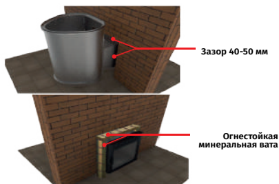
Рис.№ 5 Установка печи «Сквозь стену»
