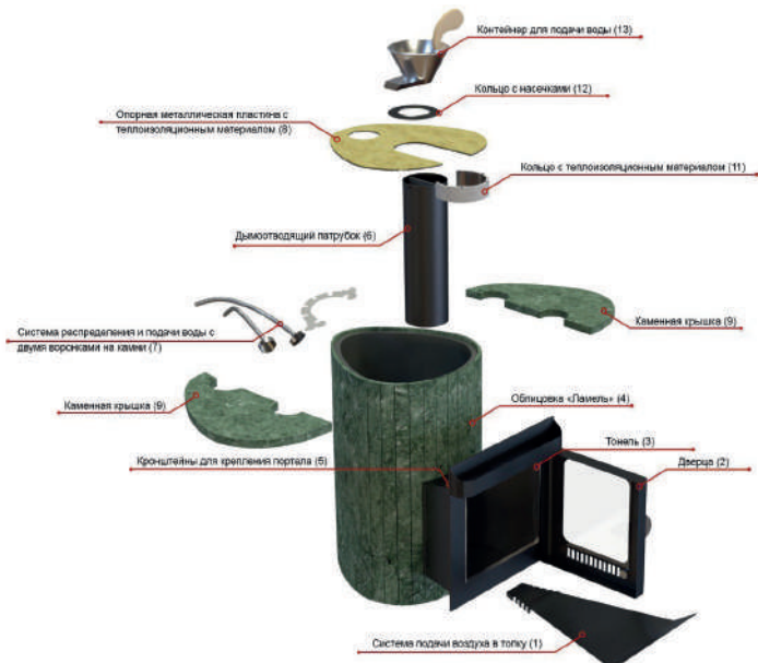
Рис.№ 7 Схема сборки печи в облицовке «Ламель»
