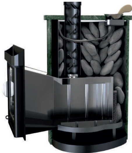
Рис.№ 14 Схема рекомендуемой закладки камня в каменку
